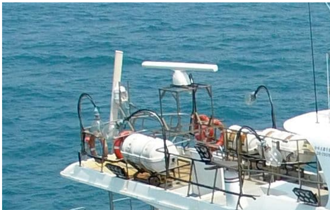
圖 2、架設於船舶上之雷達天線
