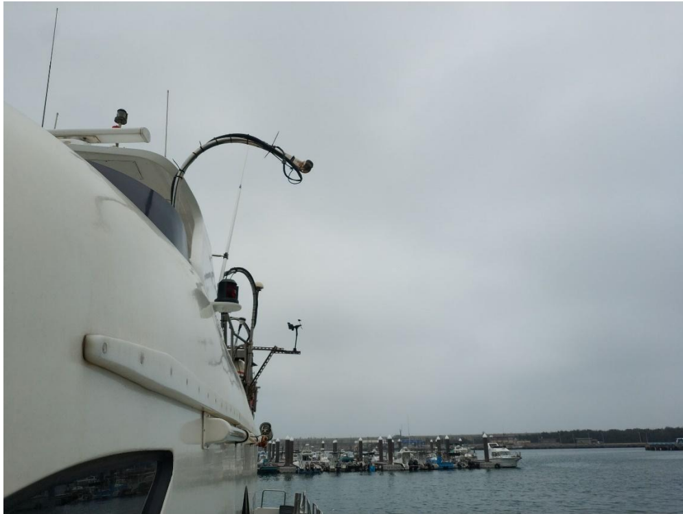
圖 2、超音波麥克風架設於海面上約 4 m 的位置
